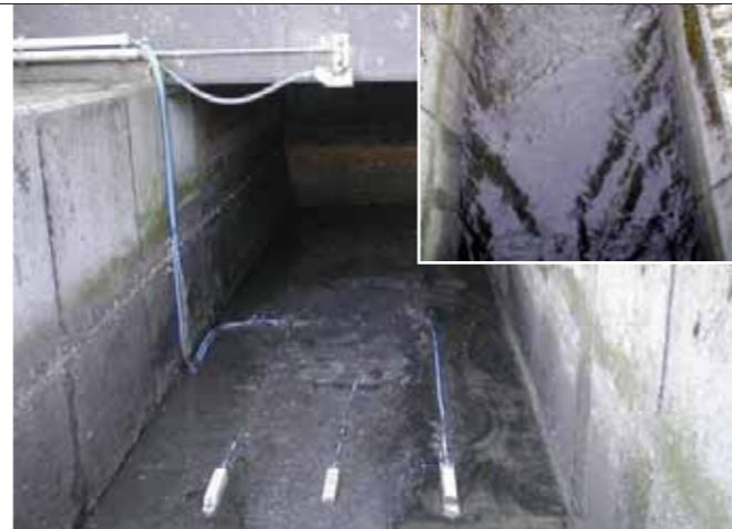
A mérési pont és az áramlási viszonyok
