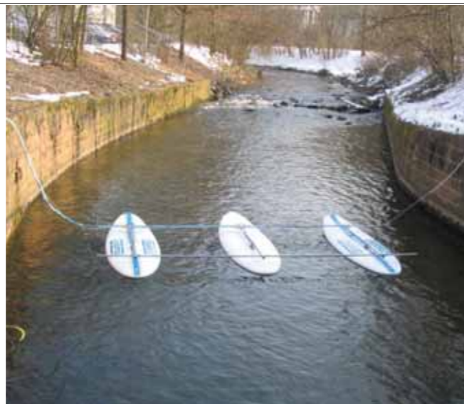
Áramlásmérési pont felszíni vízfolyásban: az érzékelők szűrődeszkák (úszótestek) aljára szerelve
