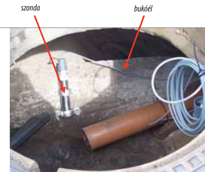
A bukóaknába beépített mérőrendszer
