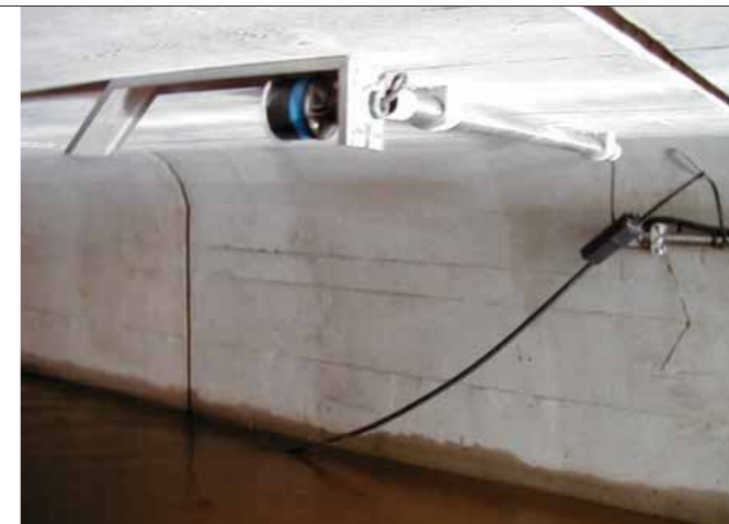
Ultraszong szintmérés döntött tükörrel
