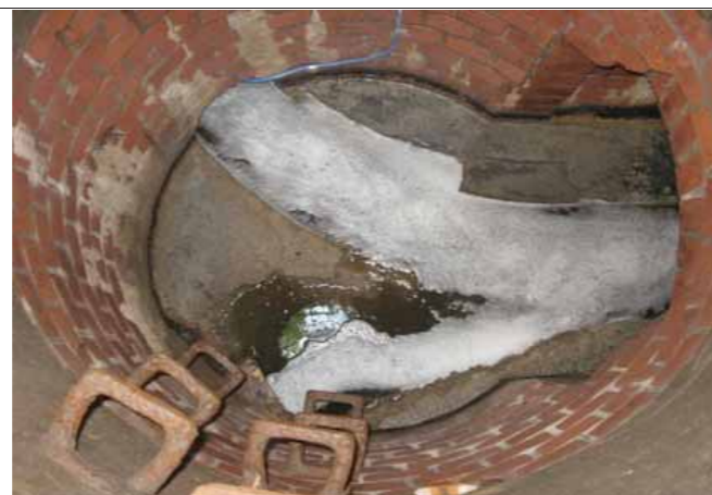
Áramlásmérés a megfelelő kiömlési pontnál (0,3 m átmérő, csatornafenekre szerelt sebesség érzékelő)
